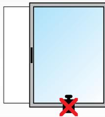
Unterlassen Sie eine zusätzliche Belastung des Schiebeflügels!
